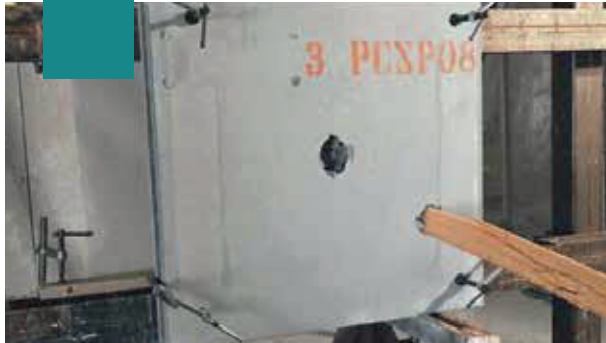
TEST DI RESISTENZA IMPATTO 4
