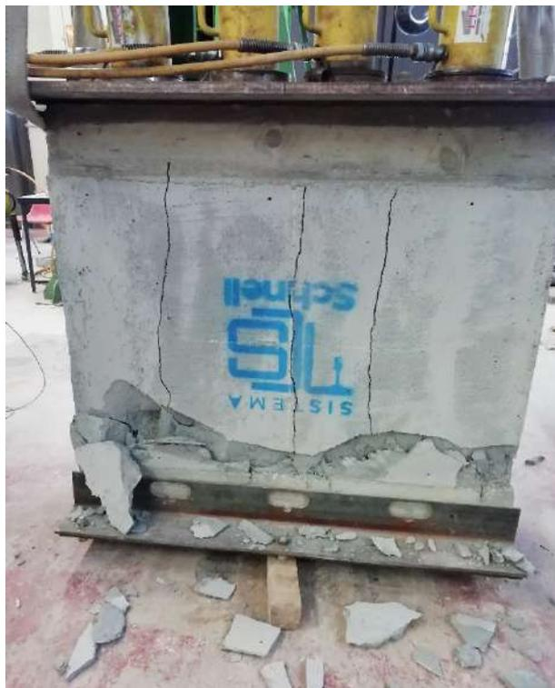
*Figura 6.15 Schiacciamento e fessurazione verticale retro CE1*
