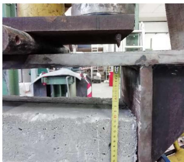
*Figura 7.4 Particolare della mancata orizzontalità del provino misurate in corrispondenza dello spigolo sinistro e destro*
