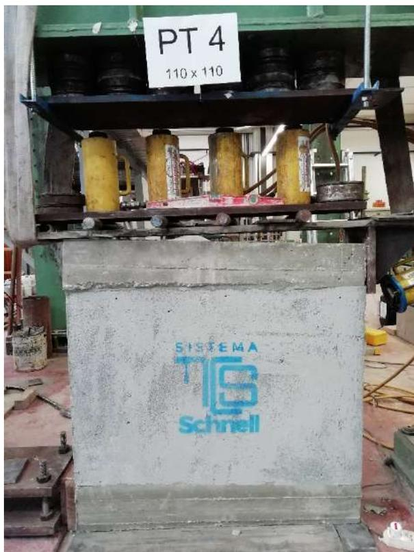
*Figura 7.3 Irregolarità costruttiva provino PT4 con evidente non planarità*
