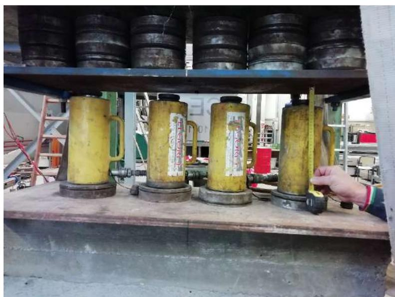
*Figura 6.14 Irregolarità costruttiva del pannello CE4 rilevata tramite eccessiva distanza ultimo martinetto-piastra di appoggio*
