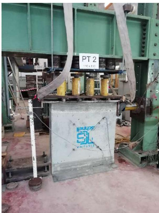
*Figura 7.2 Setup prova a precompressione e taglio*
