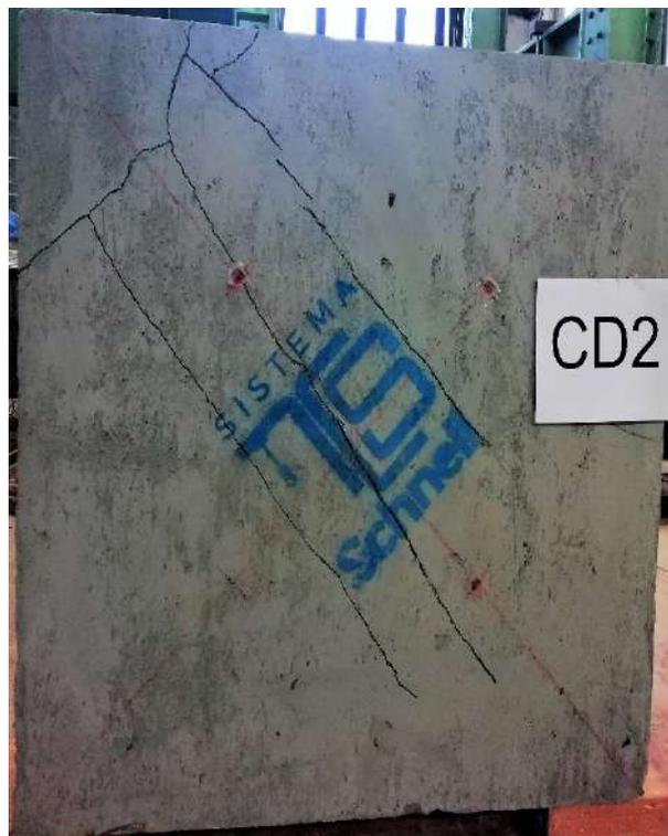
Figura 4.7 Fessurazione diagonale CD2
