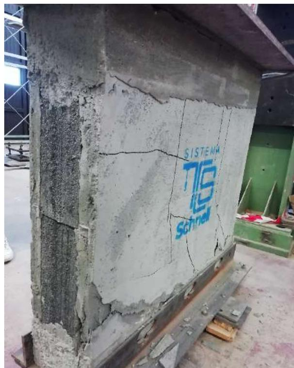
*Figura 6.18 Fessurazione verticale retro e schiacciamento CE4*
