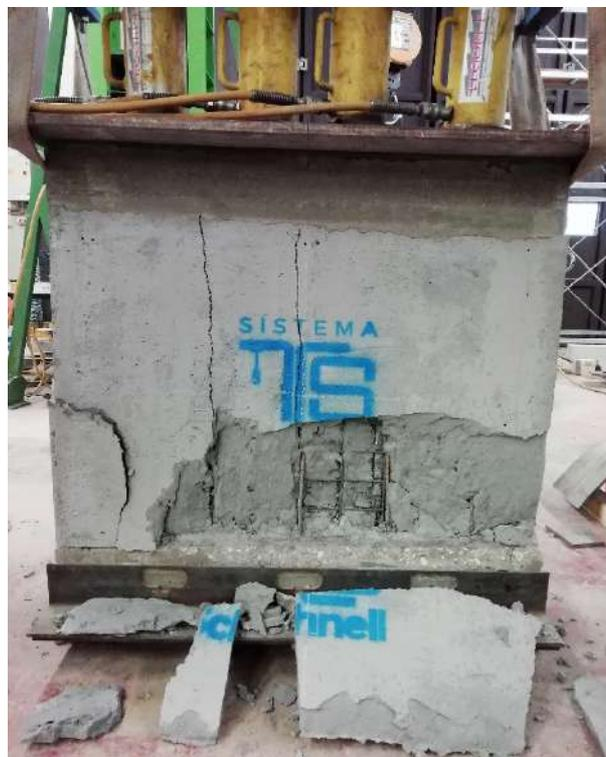
*Figura 6.16 Schiacciamento e fessurazione verticale retro CE2*
