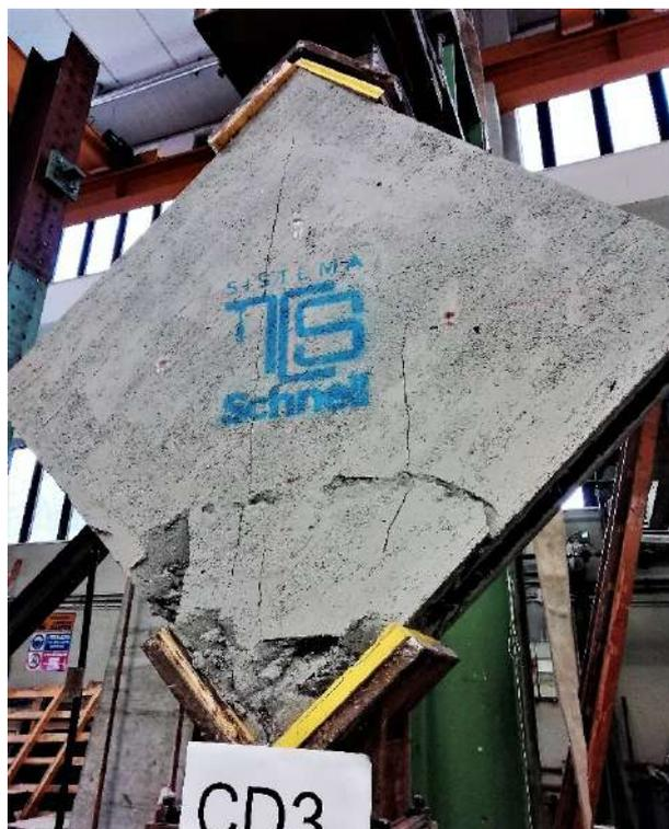
Figura 4.8 Schiacciamento spigolo e fessurazione diagonale CD3 fronte
