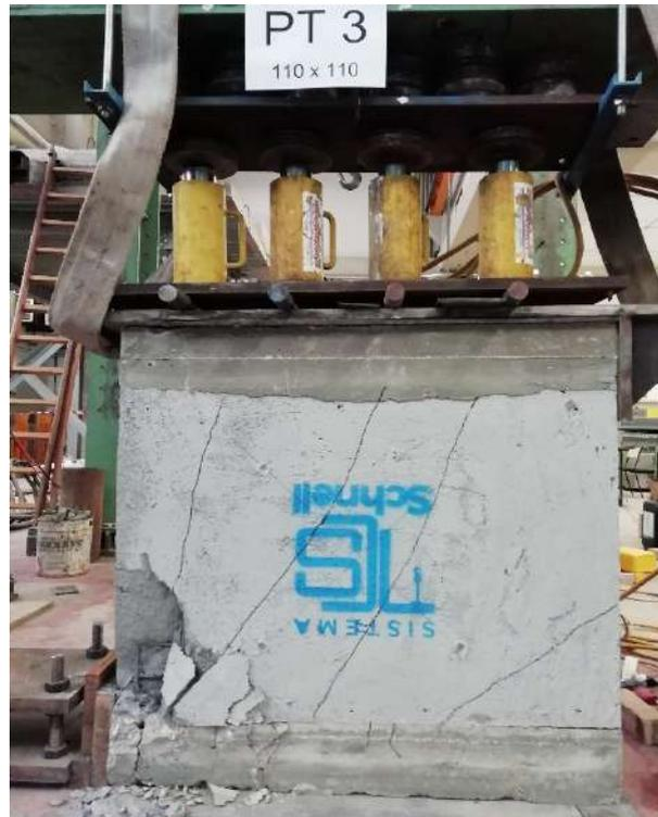
*Figura 7.9 Fessurazione diagonale e schiacciamento spigolo fronte PT3*
