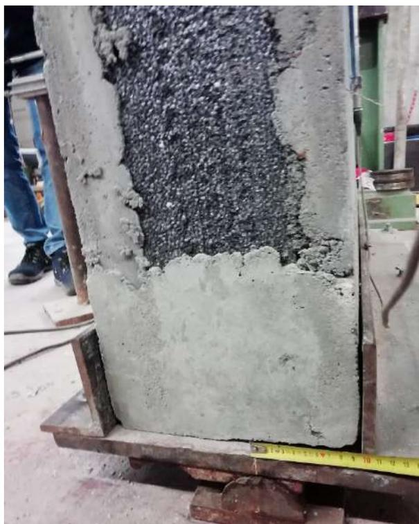
*Figura 9.1 Setup di prova – Predisposizione del provino sulla cerniera cilindrica*
