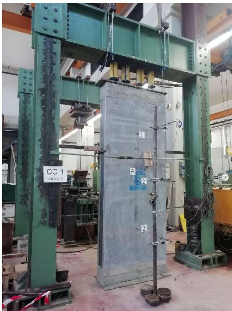
*Figura 8.1 Setup di prova – compressione centrata su provini 1100x3000 mm*
