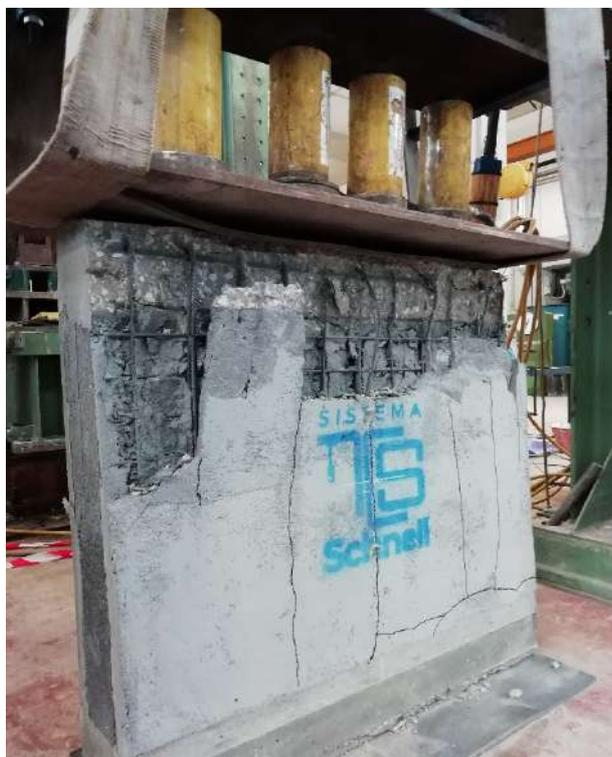
*Figura 5.10 Schiacciamento cordolo superiore provino CC1*
