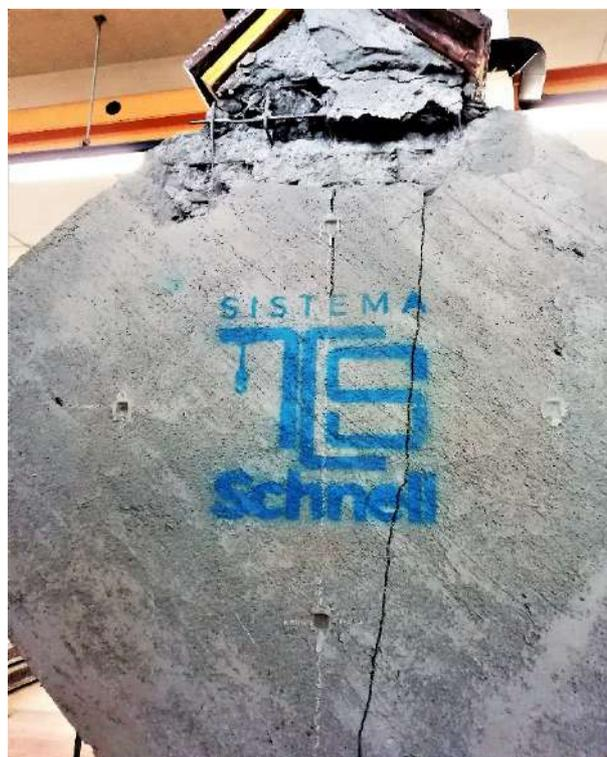
Figura 4.9 Schiacciamento spigolo e fessurazione diagonale CD4 retro
