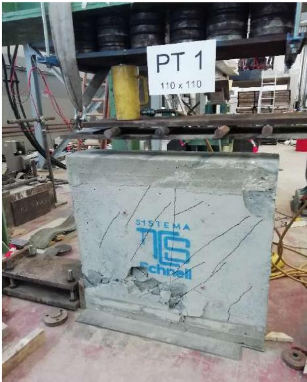
*Figura 7.7 Fessurazione diagonale e schiacciamento spigolo fronte PT1*
