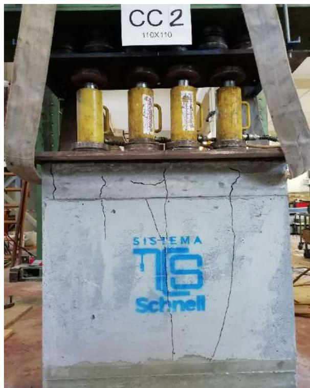
*Figura 5.11 Schiacciamento cordolo superiore e fessurazioni verticali CC2*
