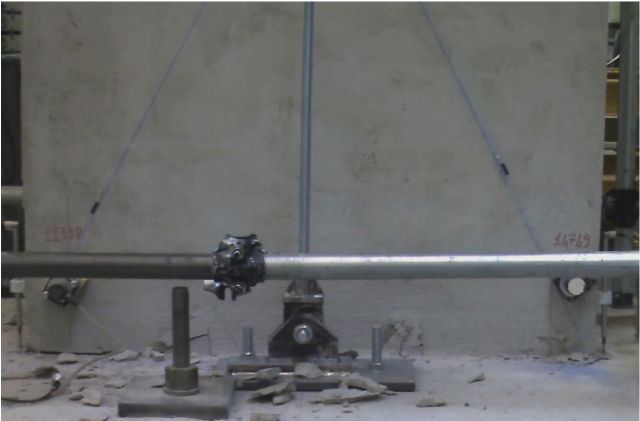
Figura 8-12 Massimo sollevamento al piede delle parete destra, sul lato sinistro, per drift 1.0%.
