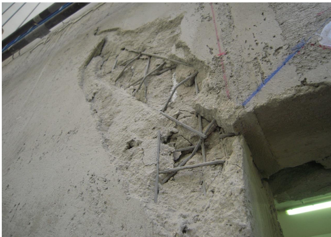
Figura 8-8 Stato di danneggiamento a fine prova della fascia di pino: particolare di sbandamento fuori piano del fazzoletto di rete di rinforzo.
