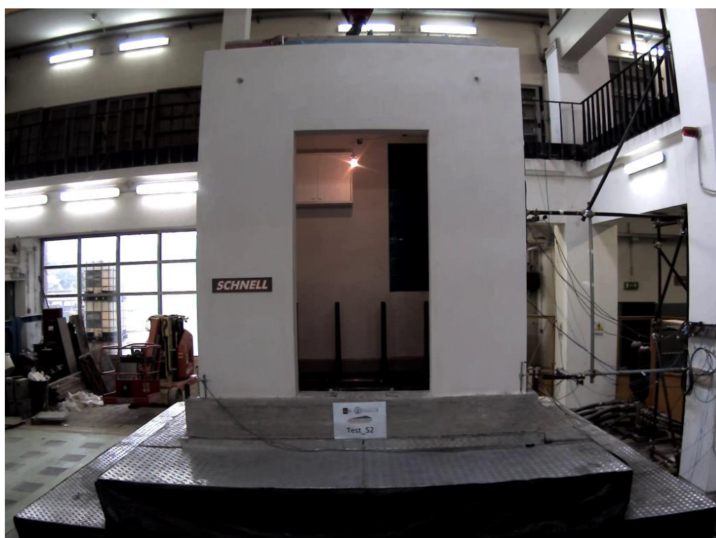
Figura 10.22 Assenza di danni al termine della prova
