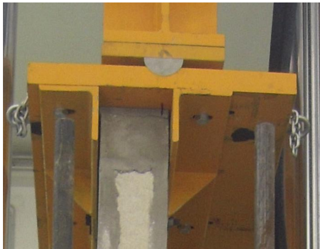
Figura 9-2 Prova di compressione eccentrica su pannello con rete da 3 mm.
