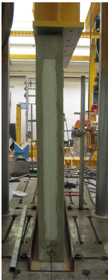
Figura 6-17 Irregolarità costruttiva dei pannelli con evidente fuori piombo.
