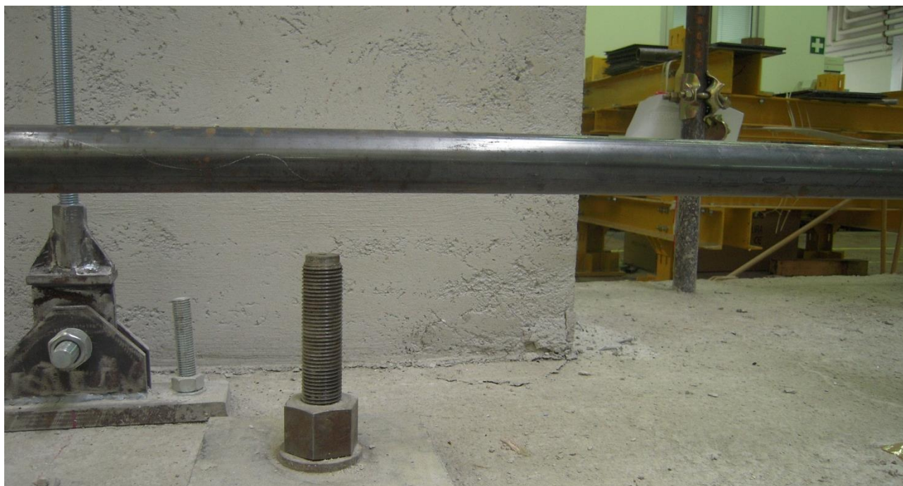
Figura 8-18 Stato di danneggiamento a fine prova alla base della parete sinistra, lato interno, con schiacciamento dello spigolo.
