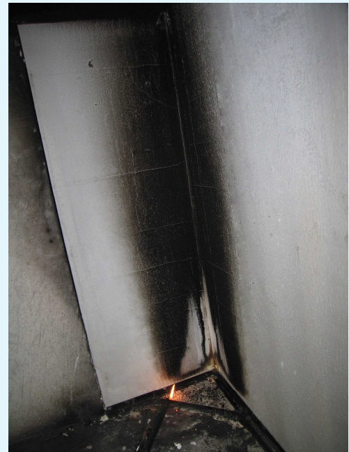
Primo piano del bordo esterno verticale dell'ala lunga dopo la prova. Close-up of the vertical outer edge of the long wing after the test.
